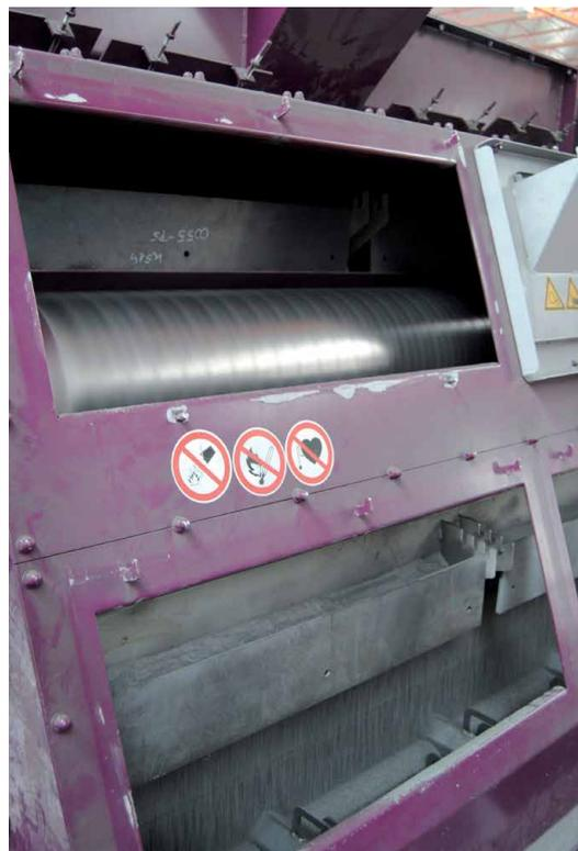
Abb. 4: Magnet-/Windsichtung mit Magnetwalze und Strahlmittelschleier
