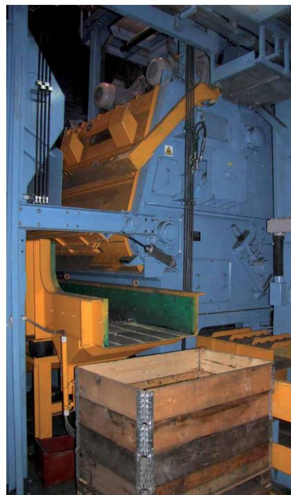
*Raupenband-Strahlanlage MR 850 mit Beschicker und Vibrorinne zur Bearbeitung von Gussteilen*
