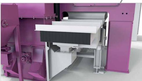
Strahlmittelreinigung durch eine Vibratorinne zum sofortigen Austrag von Graten und Abfallteilen
