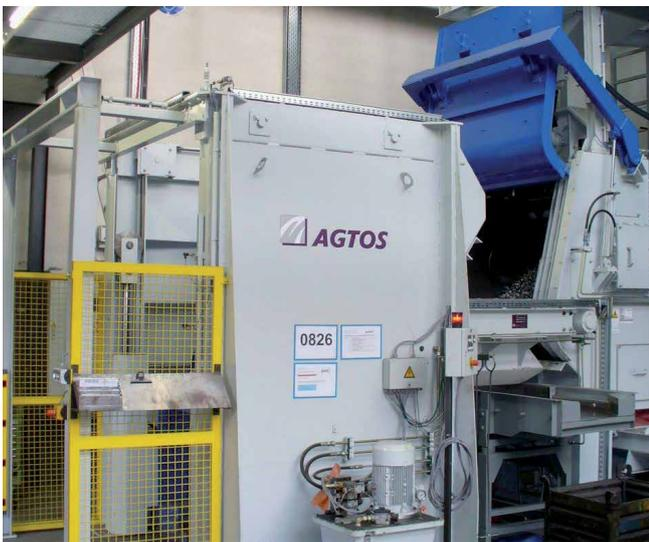
*Raupenband-Strahlanlage MR 550 mit Beschicker und Vibrorinne zur Bearbeitung von Motorkomponenten*
