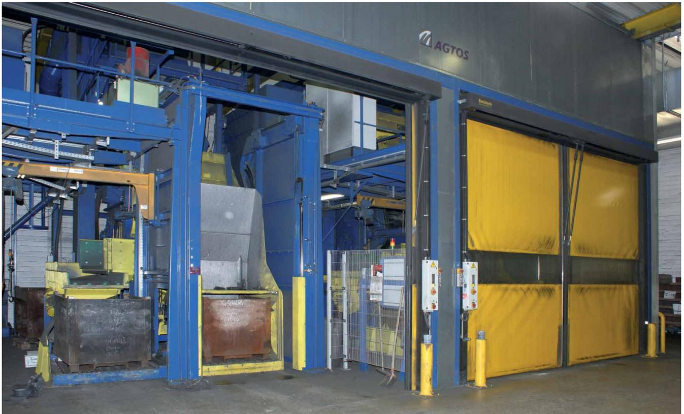
Raupenband-Strahlanlagen MR 850 im Zwillingbetrieb in einer Gießerei. Schnell-Lauftore dienen der Arbeitssicherheit und dem Schallschutz.
