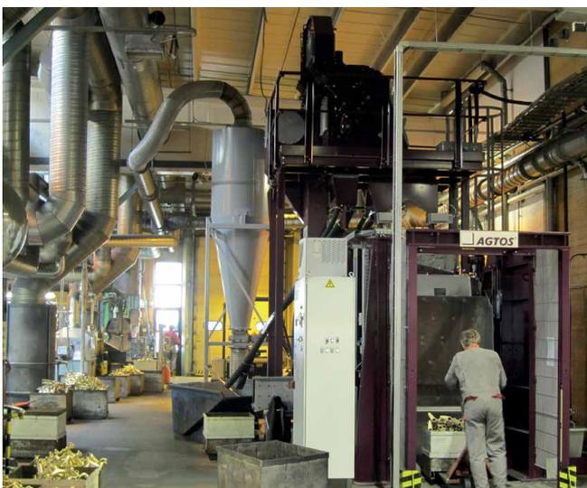
*Raupenband-Strahlanlage MR 270 zum Strahlen von Armaturteilen*
