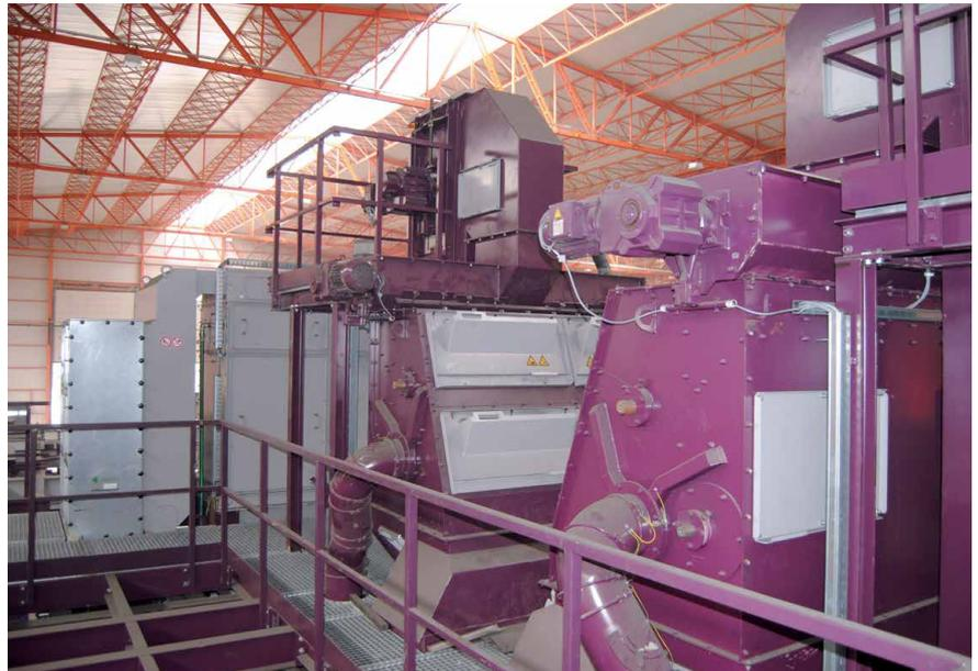
Abb. 2: Magnet-/Windsichtung in einer Gießerei-Großanlage
