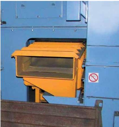
Abb. 1: Vibrorinne zum Austrag von Grobteilen aus dem Strahlmittel
