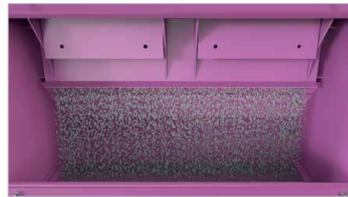
Magnet-/Windsichtung zur Strahlmittelaufbereitung
