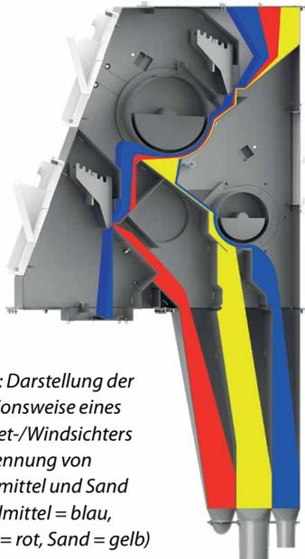
Abb. 3: Darstellung der Funktionsweise eines Magnet-/Windsichters zur Trennung von Strahlmittel und Sand (Strahlmittel = blau, Staub = rot, Sand = gelb)
