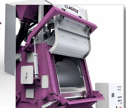
Hubtür mit zwei Zylindern für gleichmäßige, beidseitige Abdichtung
