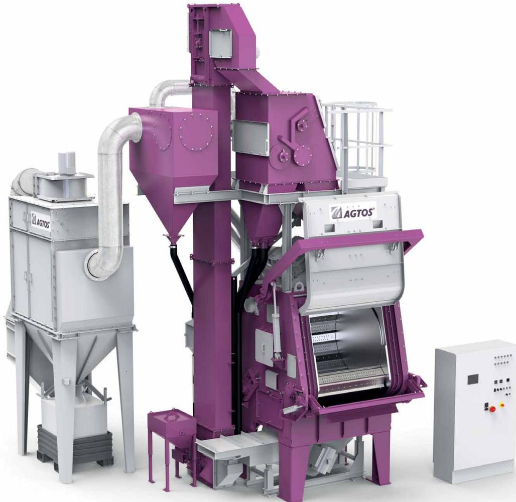
Raupenband-Strahlanlagen werden zum Entgraten, Entzundern, Entsanden und Entrosten von Massenteilen eingesetzt. Sie werden sowohl als Insellösung betrieben als auch in Linie verkettet. Neben dem Standardprogramm liefert **AGTOS** diese Maschinen in vielen Größen und Ausführungen. Die Maschinen sind mit den bewährten **AGTOS**-Hochleistungsturbinen und den wartungsfreundlichen Patronenfilteranlagen ausgestattet.
