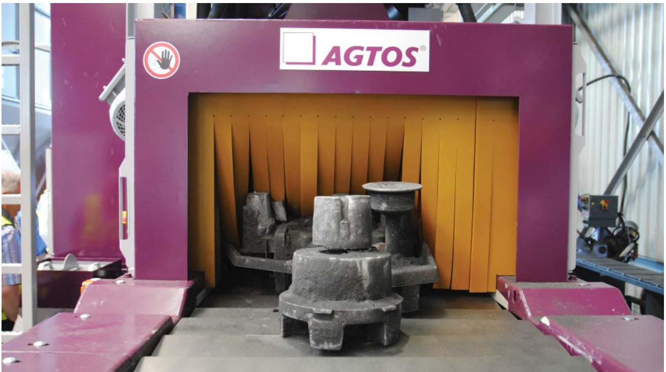
使用反弹抛丸器进行抛丸之前进行的铸件
